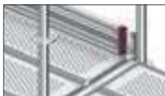
Montage des Stahlbordbretts
