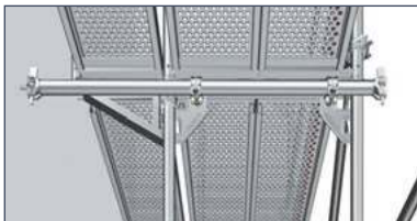
Allround Riegel als Anker mit zwei Knotenblechkupplungen
